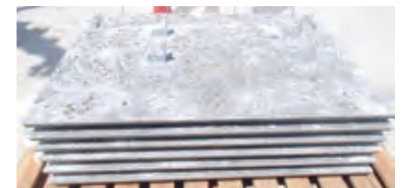
プレキャスト製埋設型枠
