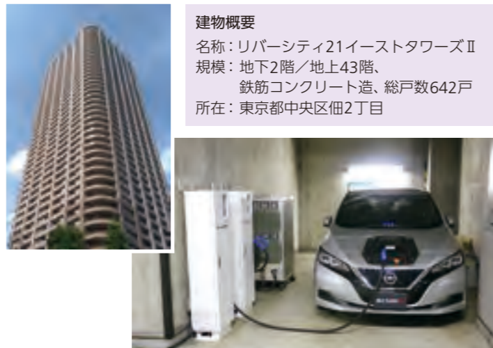
< 稼働実証が行われた超高層住宅と地下駐車場で電源供給する電気自動車 >
