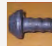
上：PCa壁高欄の実橋への適用例 下：Trunc-head先端部の拡大写真
