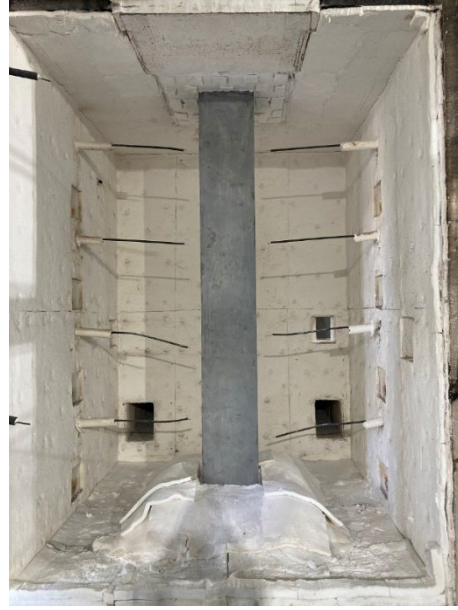
【実大载荷加熱試験（柱）】
