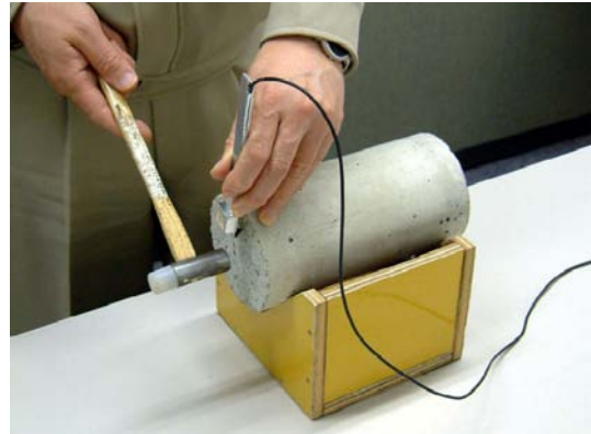
写真-1 円柱供試体の弾性波速度測定状況
