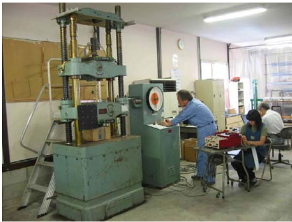
図-5 引張試験の状況
