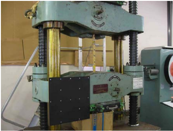
図-4 ターゲット設置状況
