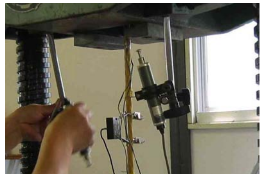
図-3 計測機器の設置状況
