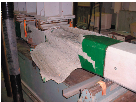
U 字+部分閉合補強の破壊状況
