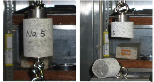
写真-9 付着強度試験状況
