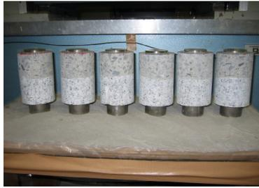
写真-8 付着強度試験供試体
