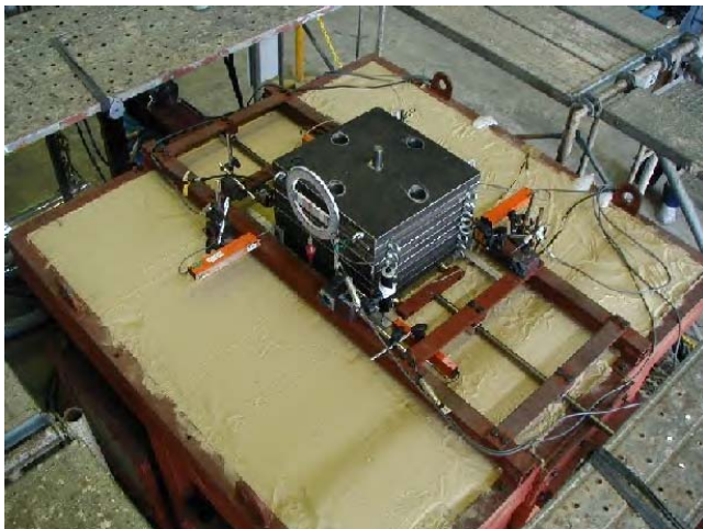
写真-1 載荷実験状況
