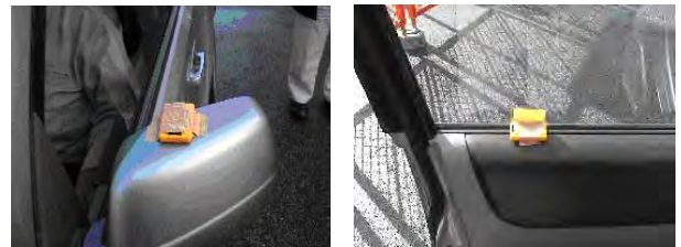
図-4 ICタグ取付状況（左：車外，右：車内）
