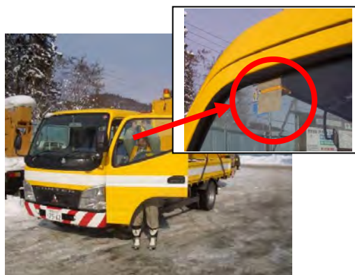
図-9 車両へのICタグ設置状況
