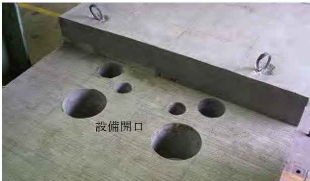
写真-4 設備開口部周辺の実験終了後の状況
