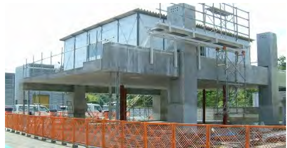
写真-1 実大架構試験体
