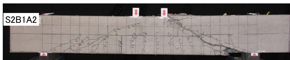
図-3 アラミド繊維補強材を使用した梁のせん断破壊状況
