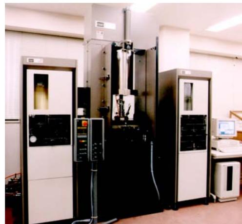
写真-1 三軸圧縮試験装置
