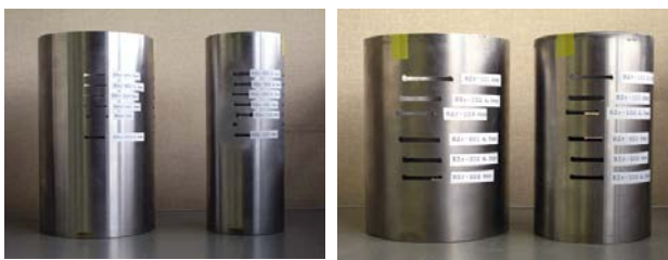
SUSモデル Zrモデル 写真-5 2重管模擬材の切断部
