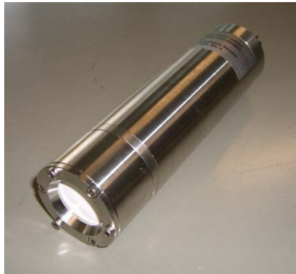
写真-1 溶存メタンセンサー概観
