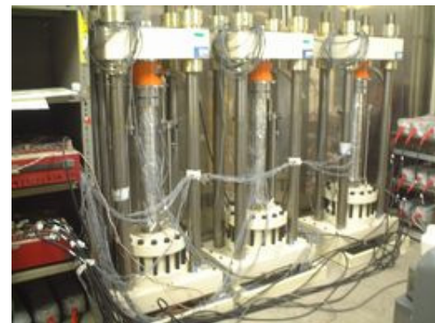
写真-1 クリープ試験状況
