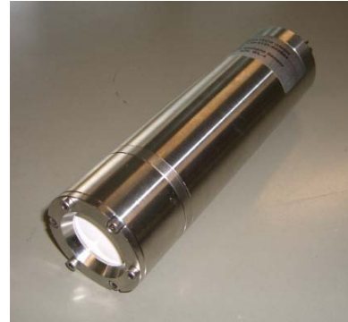
写真-1 溶存メタンセンサー概観
