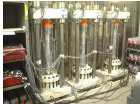
写真-1 クリープ試験状況
