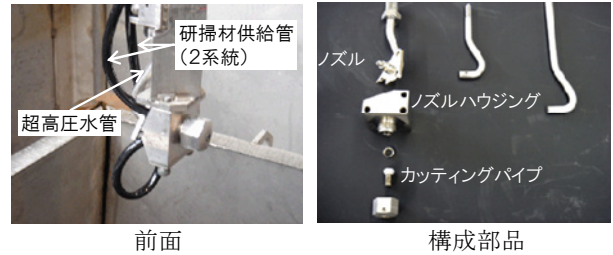
写真-1 超小型AWJカッティングヘッド
