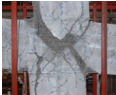
図-6 最終破壊状況 ( R=1/10 rad )
