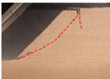
図-2 破壊状況（無補強）
