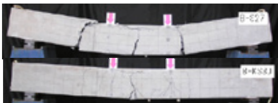
写真-3 アラミド繊維補強材を引張補強材に使用した RC はりの曲げ破壊形状
