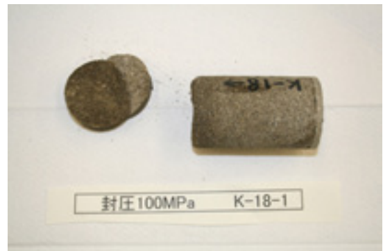
写真-6 破壊後の岩石供試体状況 (試験ケース 6 (封圧=100MPa))
