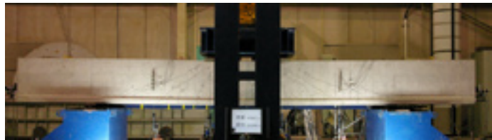
写真-2 PC はりの载荷試験
