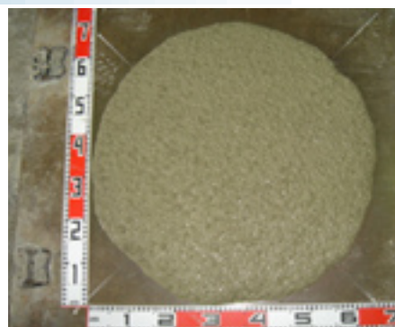
写真-1 高流動軽量コンクリートのスランプフロー試験の状況
