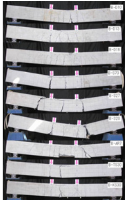
写真-2 曲げ試験体ひび割れ形状
