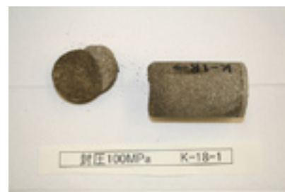
写真-3 破壊後の岩石供試体状況
