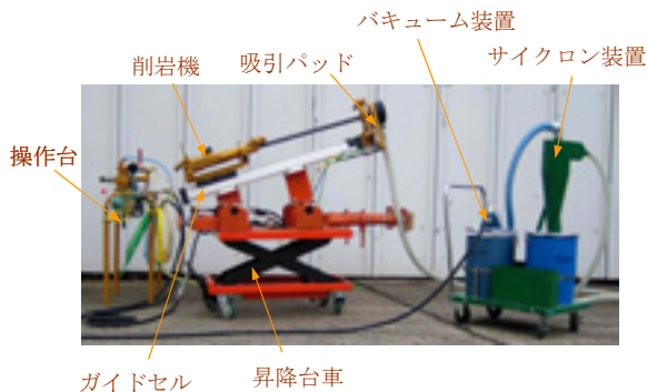
写真-2 削孔システムの構成
