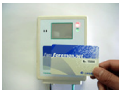
図-5 カード認証 (RFID カードと読取装置)
