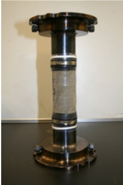
写真-3 岩石供試体のアッセンブル
