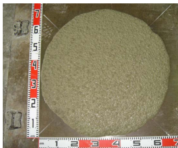
写真-2 高流動軽量コンクリートのスランプフロー試験の状況
