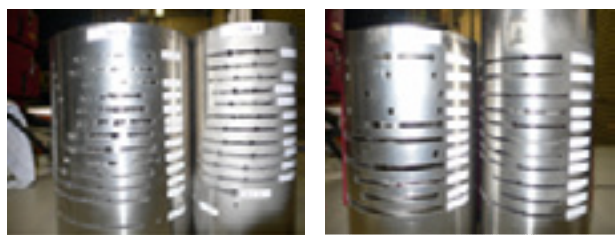
Zr材 SUS材 写真-3 二重管模擬材の切断状況
