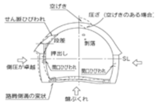
(a) 外力によるトンネル変状の種類
