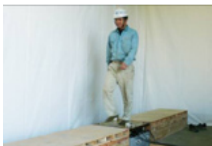
写真-1 歩行加振力の実測状況
