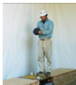
写真-2 衝撃源の加振力測定状況
