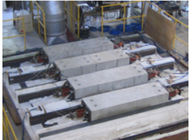
写真-1 加熱試験状況
