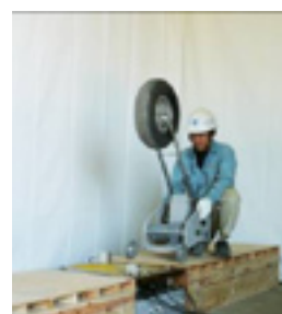
写真-2 衝撃源の加振力測定状況
