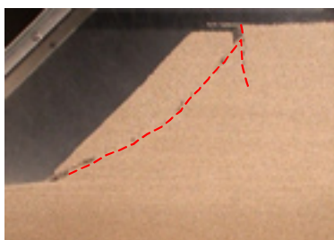
図-2 破壊状況(無補強)
