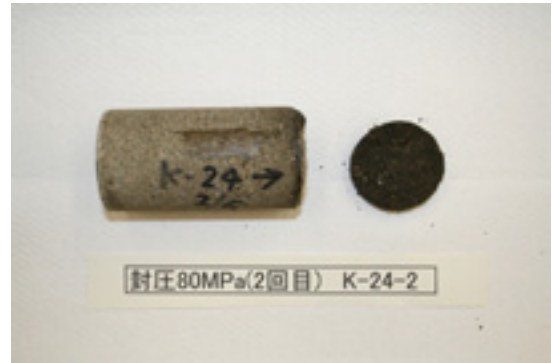
写真-5 破壊後の岩石供試体状況 (試験ケース 4 (封圧=80MPa))
