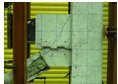
(6) AJ3SG: ブレース破壊
