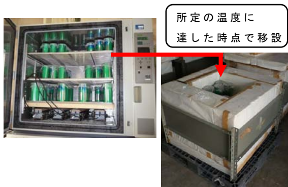
写真-1 温度可変制御槽と養生箱の概観
