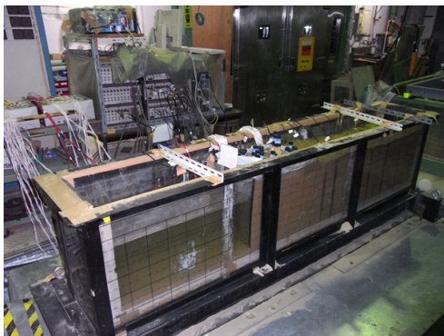
写真-1 固定土槽を用いた振動台実験の状況
