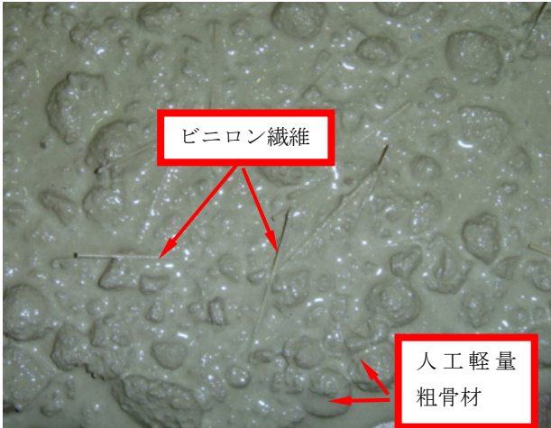
写真-3 ビニロン繊維を混入した高流動軽量コンクリートのスランプフロー試験の状況
