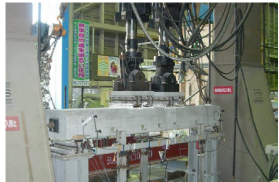
写真-1 疲労載荷試験
