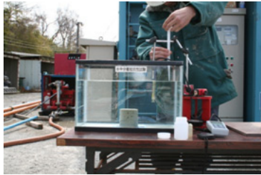
写真-9 水中分離抵抗試験
