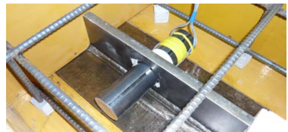
(鋼管充填コンクリートジベルタイプ)
