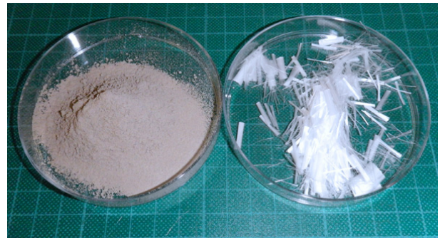
写真-2 低弾性高じん性セメント系複合体に使用する特殊粉体と短繊維
