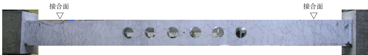
図-9 最終破壊状況
