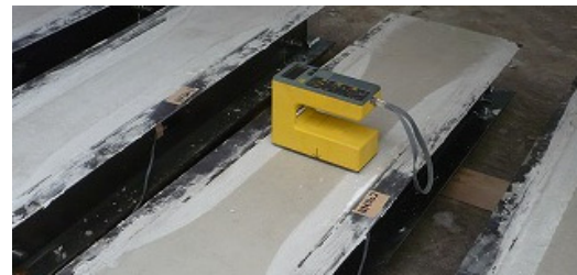
写真-1 水分計による含水率測定
