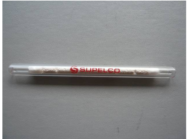
写真-1 捕集管（Tenax-TA）
