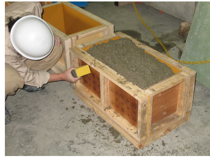
写真-1 試験体と水分計測定状況
