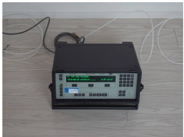
写真-3 簡易測定法（マルチガスモニタ）
