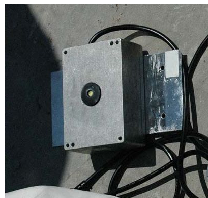
図-3 LED光源(測量標点)
