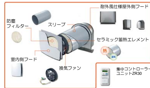
図-2 ダクトレス熱交換換気ユニット
