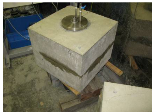
写真-1 漏水状況
