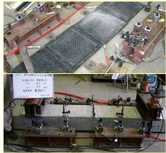
写真-1 ゴムバッグ (上) と荷重試験状況 (下)
