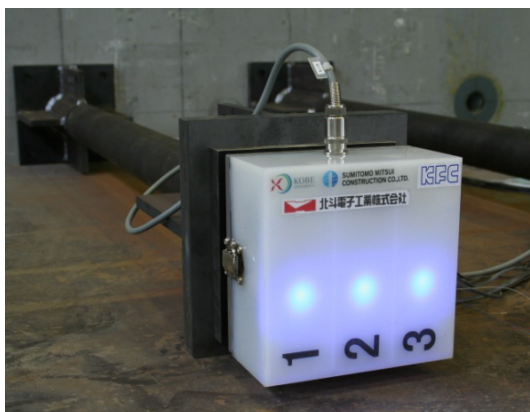
写真-3 ロックボルト引張試験状況
