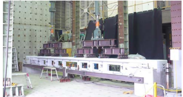
写真-1 試験体の曲げ載荷実験状況
