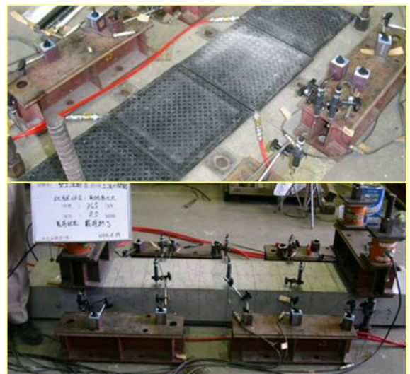
写真-1 荷重試験状況 (上はゴムバッグ)
