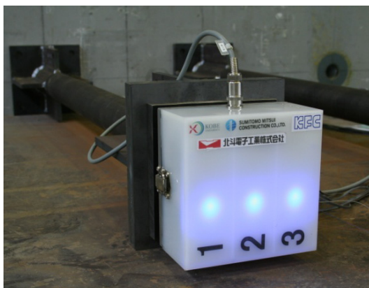
写真-3 ロックボルト引張試験状況
