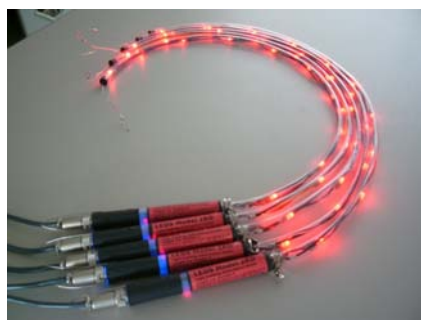
写真-1 光る変位計 LEDS の外観
