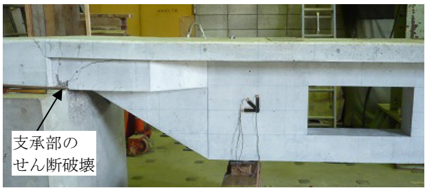
(1) I端支承部
