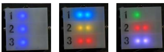
写真-3 载荷過程における発光色の変化
