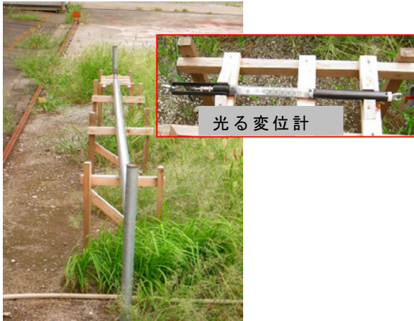
写真-2 LEADSによる模擬地滑り測定状況
