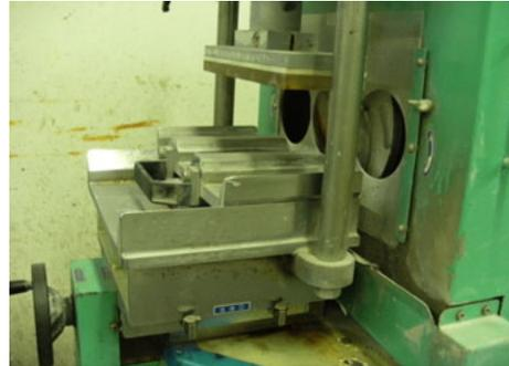
写真-1 コンクリート用端面研磨機
