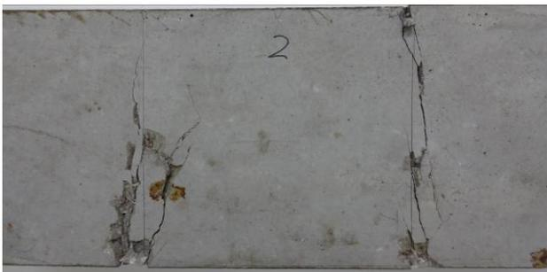
写真-3 ひび割れを発生させた供試体
