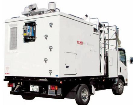
写真-1 走行型画像計測車両【MIMM】
