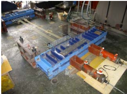
写真-2 アラミド緊張材緊張状況
