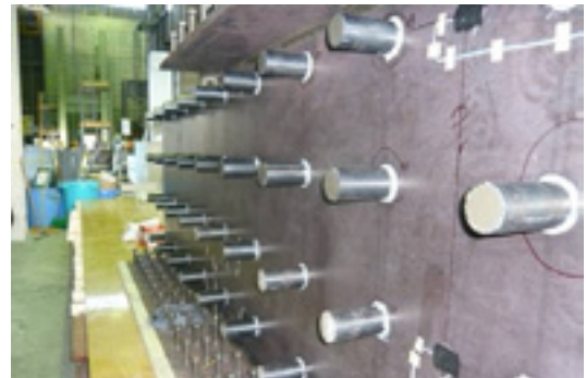
写真-2 ウェブに設置した鋼管ジベル
