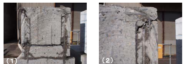
写真-1 試験体切断面 (引張実験)
