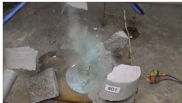
写真-4 放電破砕による円柱供試体破壊
