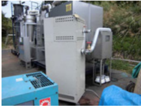
図-12 触媒式排ガス処理装置試験状況
