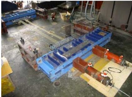
写真-2 アラミド緊張材緊張状況
