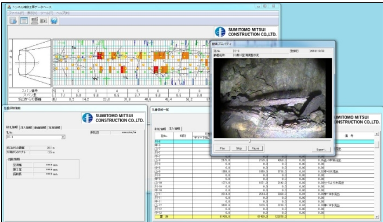
図-8 覆工背面空洞状況の動画検索
