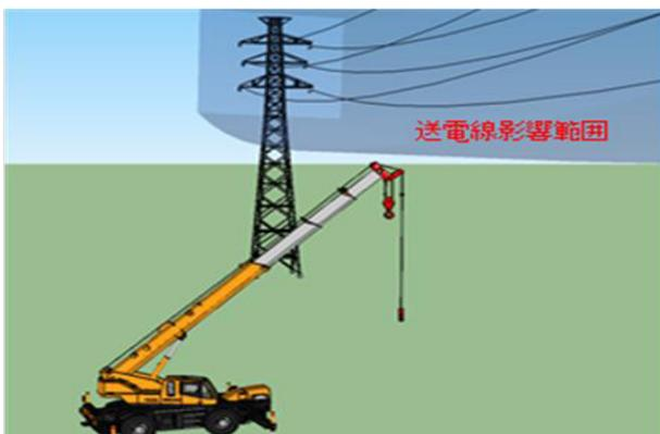
図-2 送電線近接工事の概念
