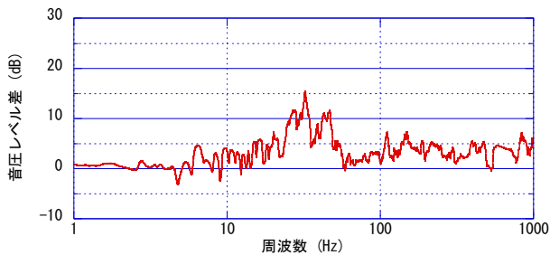
図-6 基本形状に対するスリット型吸音機構の効果
