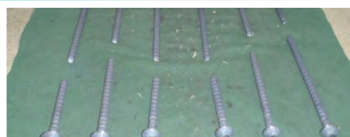
写真-1 引張試験の破断状況
