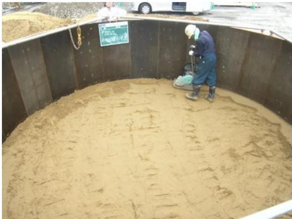
図-5 模擬地盤作製状況 (地盤作製)
