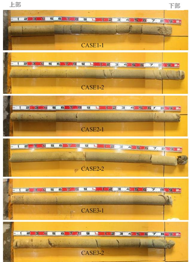
図-16 改良杭の深度方向サンプル
