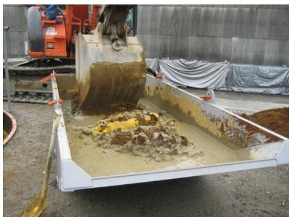
図-6 模擬地盤材料の練混ぜ状況
