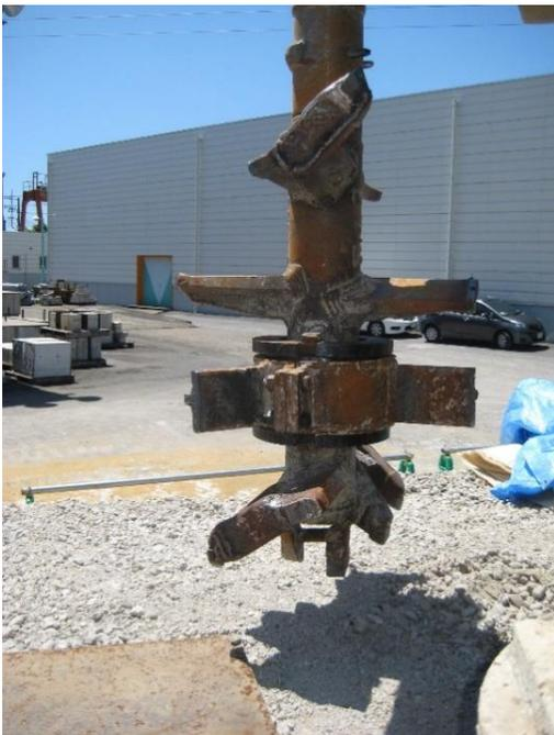
図-9 攪拌ヘッド(φ600mm)
