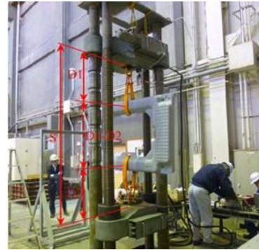
写真-3 載荷装置と計測位置
