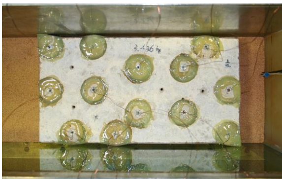
写真-1 杭および表層改良層の模型(I2d-c)
