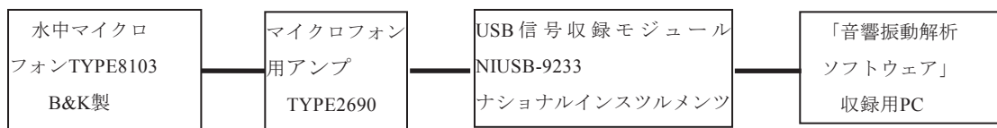
図-2 音圧レベルの計測システム
