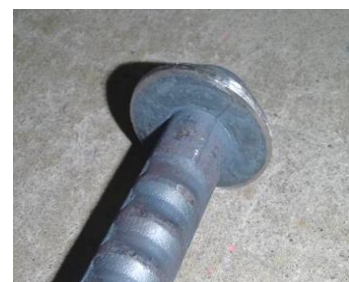
写真-1 Trunc-head (端部拡径鉄筋)
