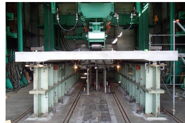
写真-4 輪荷重走行試験体状況
