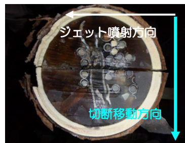
写真-1 燃料集合体溶融模擬材の切断断面
