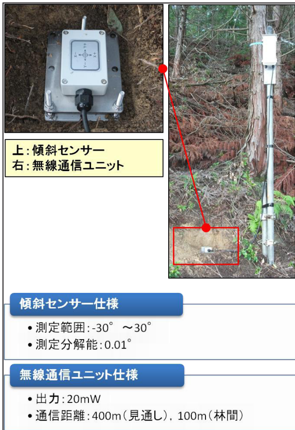
図-1 加速度センサーを用いた地盤傾斜計
