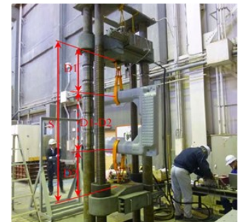
写真-2 係留索取付け部強度実験
