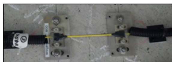
写真-1 FBG 光ファイバーひずみセンサー
