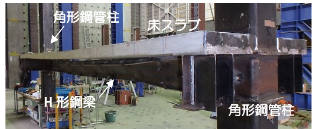
図-2 S65の横座屈状況
