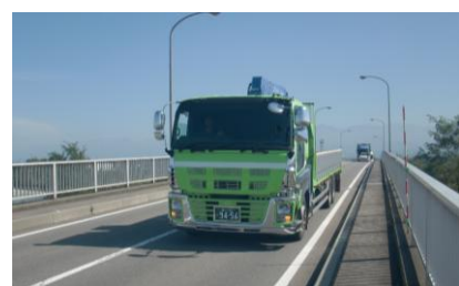
写真-5 走行載荷試験状況
