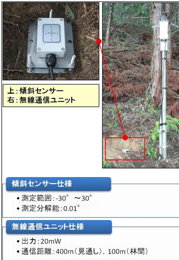
図-1 加速度センサーを用いた地盤傾斜計
