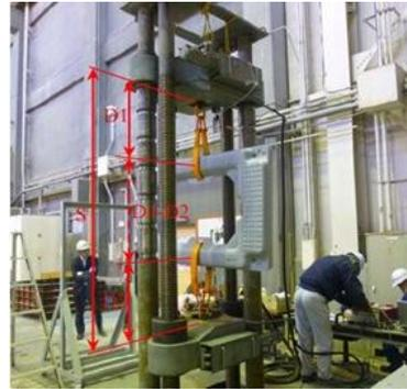
写真-3 載荷装置と計測位置
