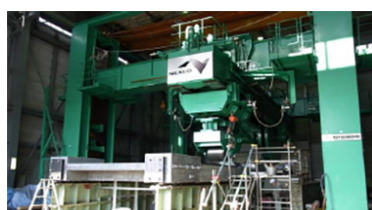
床板の輪荷重走行試験
