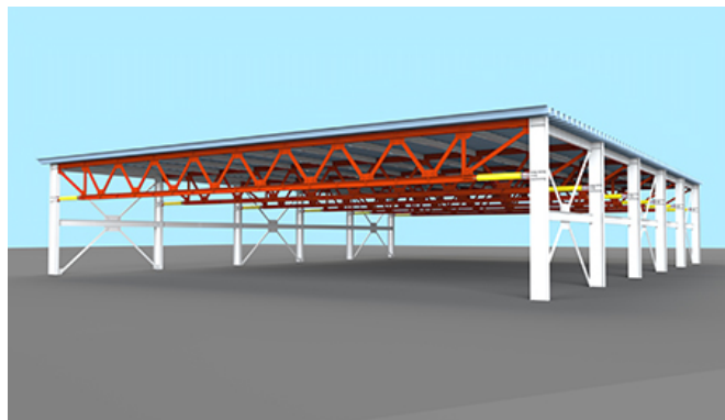
損傷制御型トラス梁構法「雷靱（RAIJIN）™」
