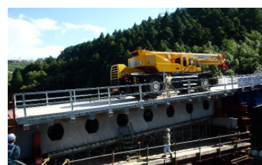
実証橋のクレーン載荷試験
