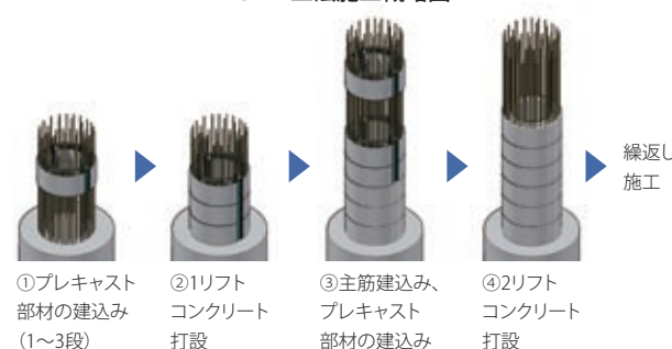
SPER工法施工概略図
