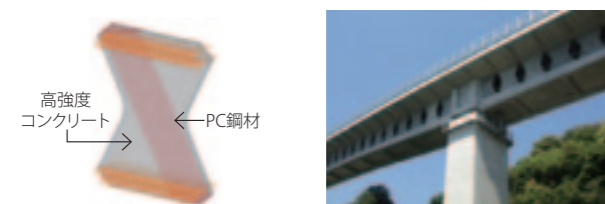
コンクリートパネル構造図
