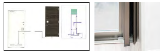
(左) 換気機能付き玄関ドア (右) 定風量給排気換気スリット付サッシ
