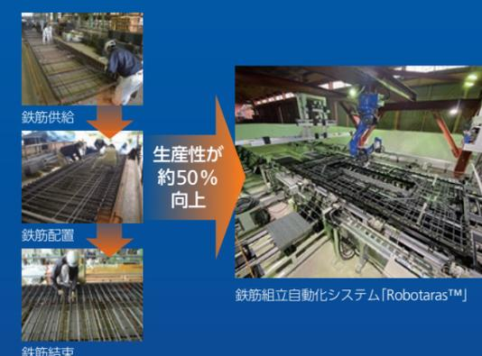
ロボットによる鉄筋の配置と結束作業の自動化
