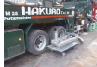
コンクリートポンプ車 (黒鉛浄化装置)
