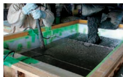
施工しやすい流動性を持つ超高強度コンクリート
