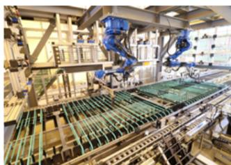
鉄筋組立自動化システム「Robotaras®」を実運用しています。鉄筋総重量の約85%を自動化することで、3倍の生産性向上を実現しています。システム稼働時に人やものが安全柵内に入ると、装置が自動停止します。
